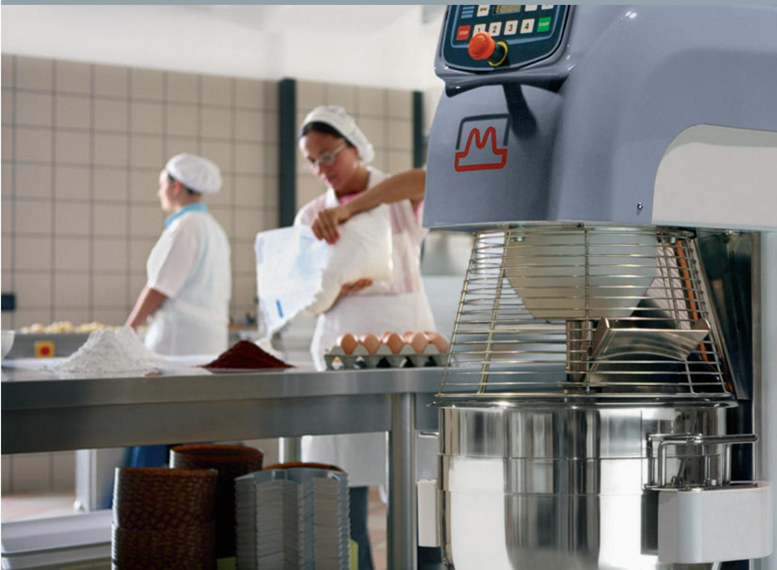
Le mescolatrici planetarie Serie MX sono state ideate per le pasticcerie di piccole e medie dimensioni e si caratterizzano per la flessibilità di funzionamento e per l'elevato livello qualitativo dei componenti utilizzati. Sono disponibili nelle versioni da 20, 40, 60 e 80 litri con possibilità di kit riduzione vasca.
