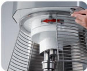
Sgancio protezione vasca / Bowl safety release / Décrochage protection cuve / Desenganche de protección de perol / Ansteckkupplung für Kesselschutz
