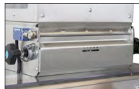
Zentral einstellbare Einlaufklappen im Trichter mit Größenanzeige
