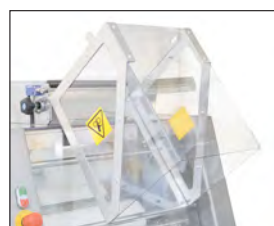
Schutzabdeckung zur einfachen Reinigung kippbar
